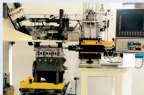
**Stazione automatica di piantaggio e avvitatura tappi a scodellino e filettati su basamento motore 4 cilindri**
