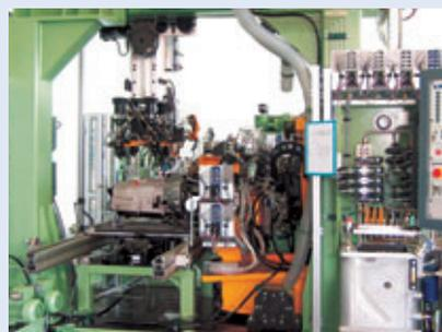
**Stazioni automatiche di estrazione olio da motore assemblato, su linee di montaggio, con impianto per la raccolta e il riutilizzo dell'olio estratto**
