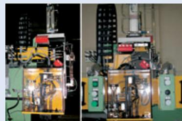
**Stazione automatica di riempimento cambio olio ed esecuzione cicli di cambio marce con rotazione albero primario per favorire il corretto riempimento**
