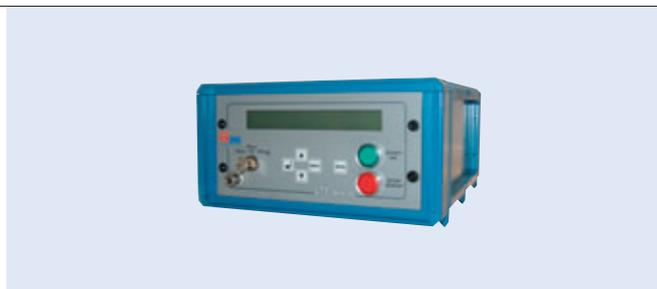
**Delta 3S** misura differenziale riferita ad una camera campione. Utilizza un trasduttore di pressione relativo per la pressione in prova, un trasduttore differenziale per la prova di tenuta.
