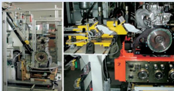
**Stazione automatica di piantaggio guarnizione albero distribuzione con verifica parametri forza spostamento impiegati e selezione due tipi di guarnizione**
